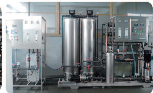
丽水晶艺饰品有限公司 (1m 3 /h反渗透+EDI水钻用高纯水设备)
