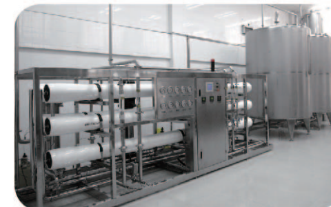
山东聊城华康生物科技有限公司(10m 3 /h 二级反渗透纯化水设备) 催化剂行业用水 Shandong liaocheng huakang biological science &technology Co.,Ltd (10m 3 /h our two stage water purifying system)
